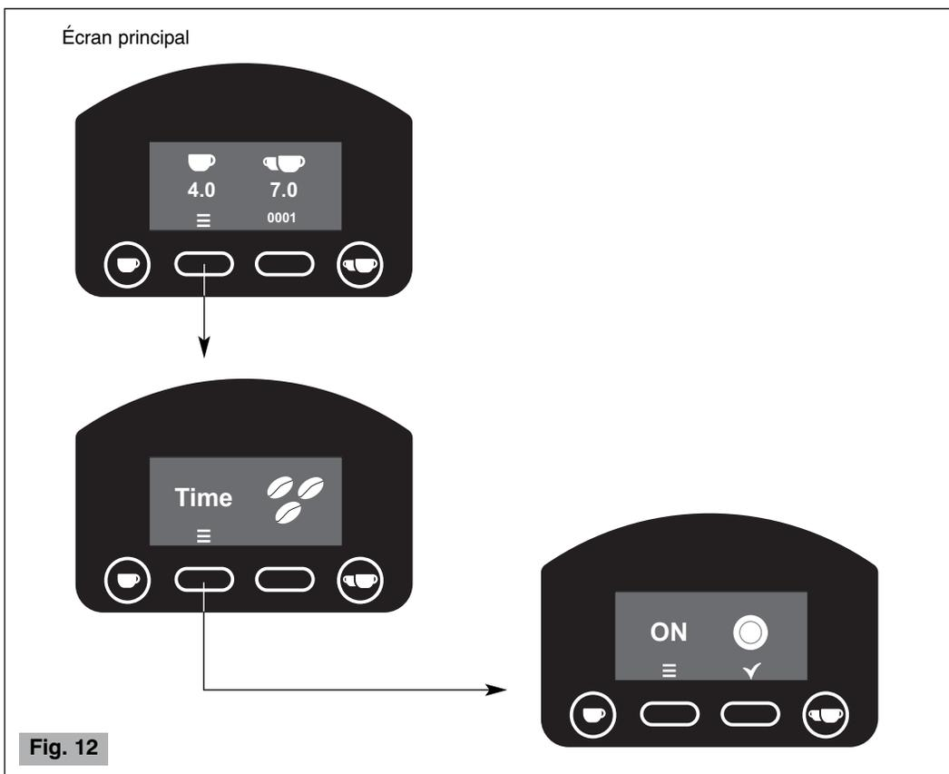
Dans l'écran du **bouton de démarrage**, en appuyant sur le bouton
