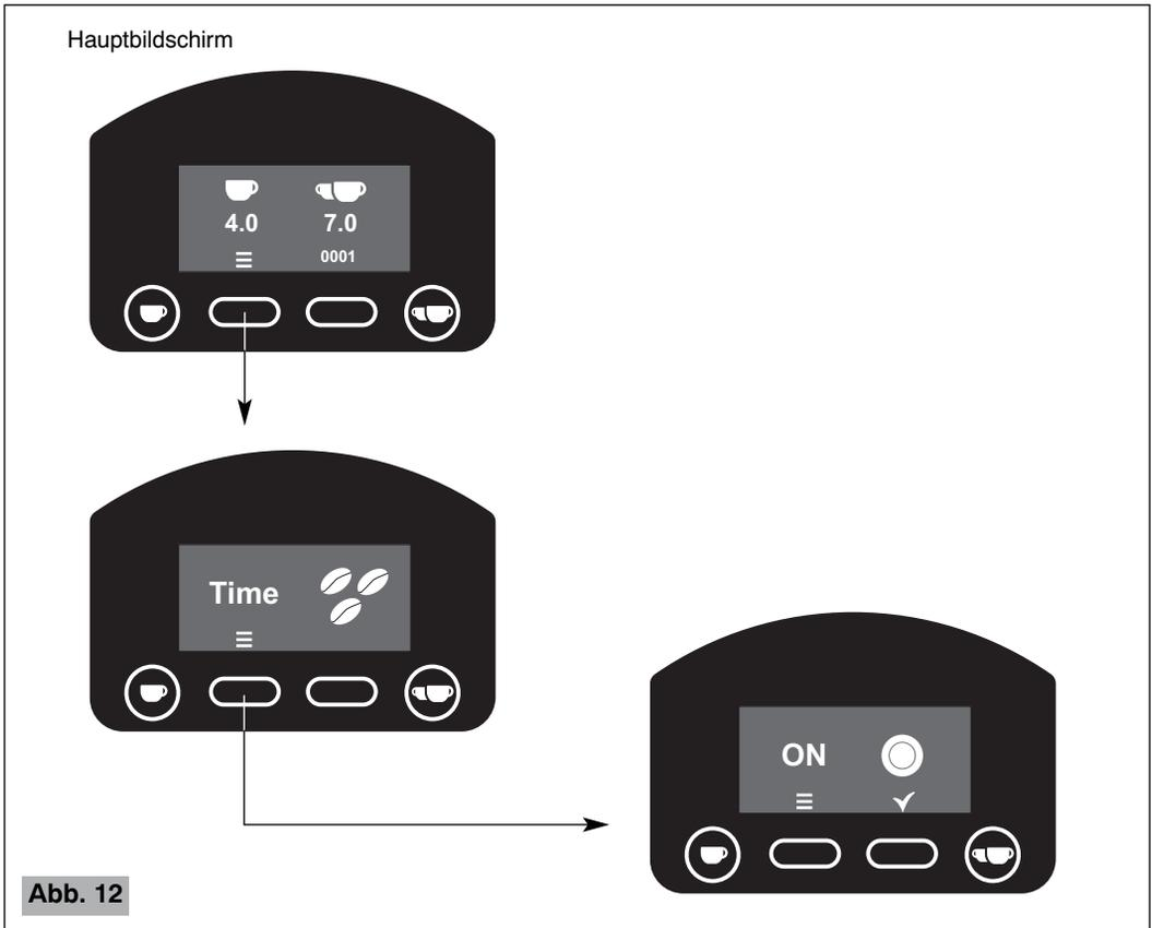
Am Bildschirm der **Starttaste** kann durch Drücken der Taste
