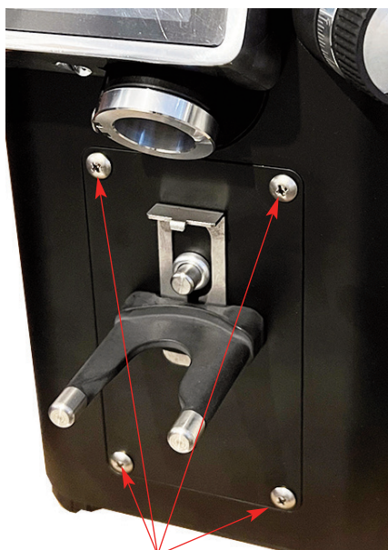
Desatornillar los 4 tornillos del módulo
