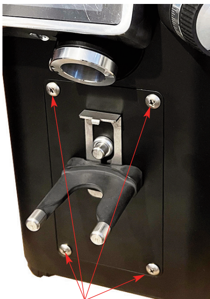
Die 4 Schrauben des Moduls abschrauben
